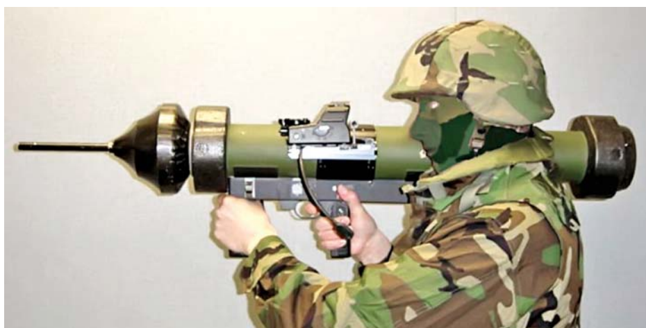
Варијанта RGW-90WB са ирсћенасћом бојевом главом има могућности пробијања ирсћирокуог зида од цигле и, уједно, сћварања оћвора величине човека
